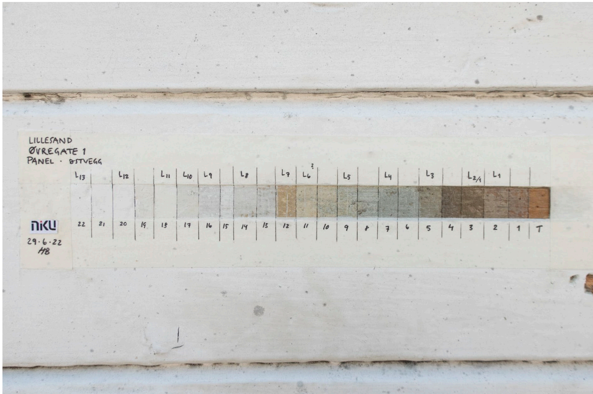
Figur 12 Lagvis avdekking på veggpanelet. Avdekningen er laget i søndre del av østfasaden. L1 er tynt, men er et klart definert topplag. Foto: NIKU, 2022.
