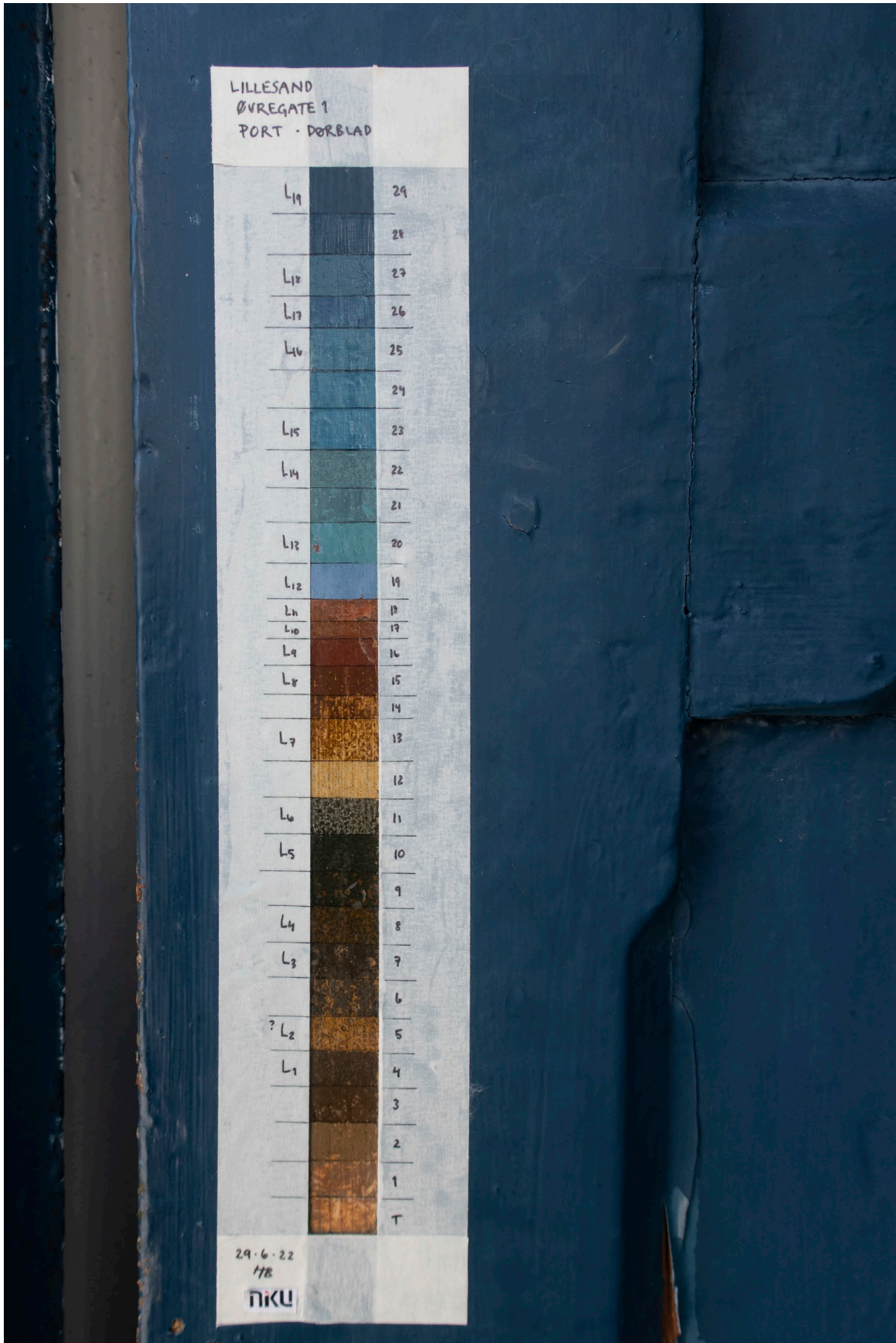
Figur 22 Lagvis avdekking på portens dørblad. Avdekningen er laget på ramtreet på søndre dørblad. Speilene i døra har hatt samme brunnyanse som ramtreet. Foto: NIKU, 2022.
